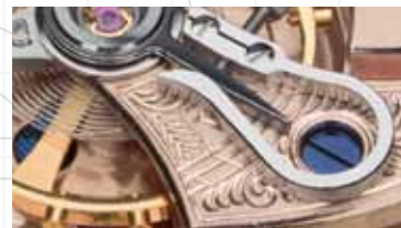
Feinregulierung mit Schwanenhalsfeder auf dem handgravierten Unruhkloben
