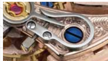
Feinregulierung mit Schwannenhalsfeder auf dem handgravierten Unruhkloben
