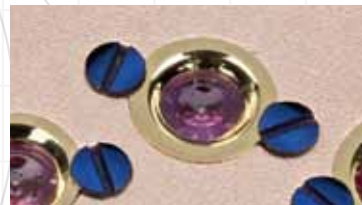
Goldchatons verschraubt mit flammegebläuten Schrauben
