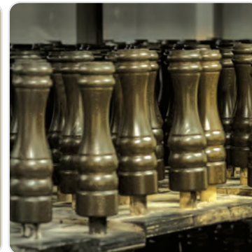
Trocknungsphase der Körper
