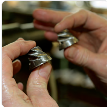
Mahlwerkkegel mit 2-Stufen-Technik
