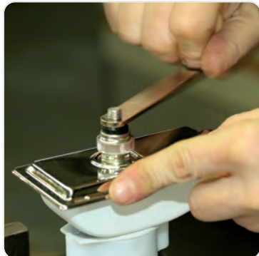
Montage der Kurbel mit der Mahl-Einheit
